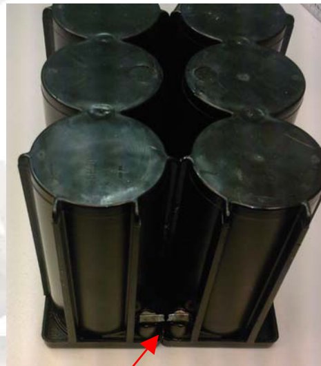
4.2 Beispiel einer gebrochenen Brücke
