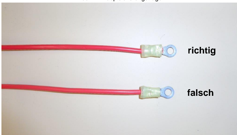
Abb. 2 – Crimpverbindung richtig/falsch (äußerlich)
