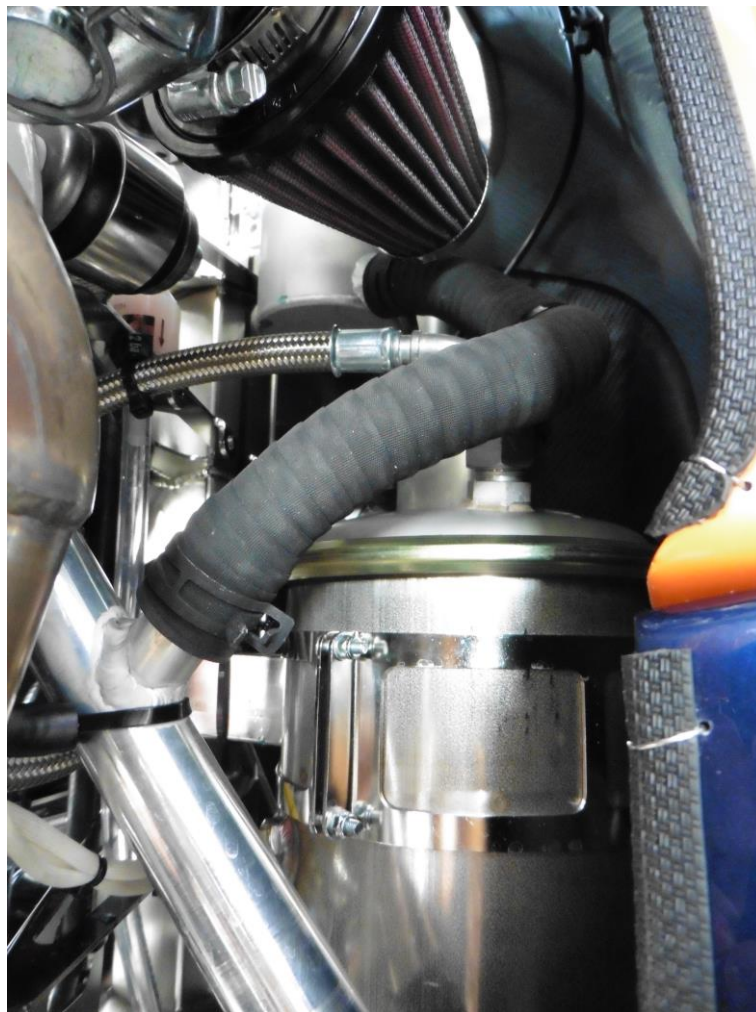
Abb.10: Verbindung Ausgleichsbehälter und Wasserverteilerrohr mit seitlichen Wasserkühlern und Lufthutzen
