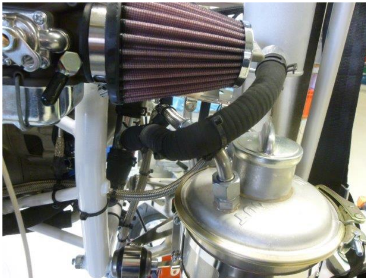
Abb.8: Verbindung Ausgleichsbehälter und Wasserverteilerrohr mit einem Wasserkühler hinten
