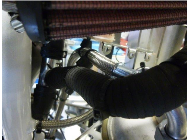
Abb.9: Verbindung Ausgleichsbehälter und Wasserverteilerrohr mit einem Wasserkühler hinten
