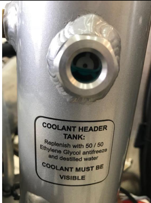
Foto des Sichtfensters mit gezeigtem Kühlflüssigkeitsmeniskus
