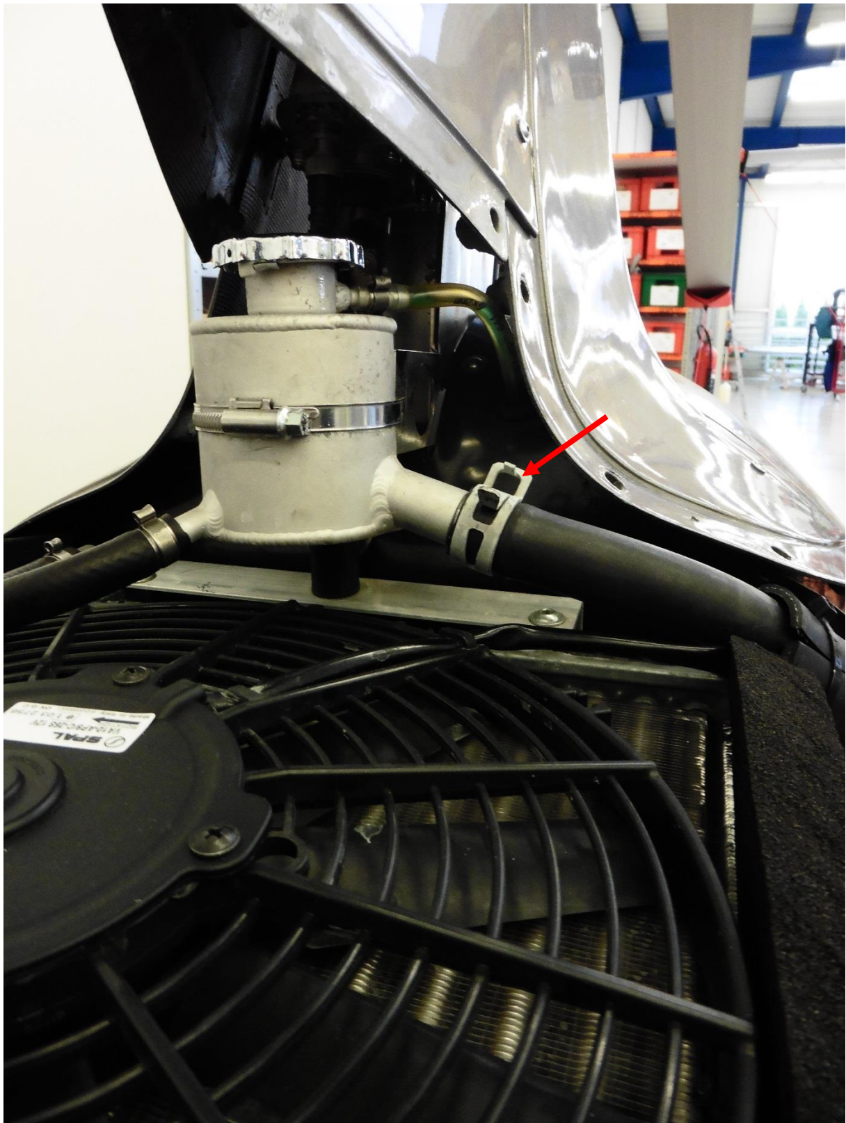
Bild 3 Federbandschelle am Kühlwasserschlauchende (Drucktankseite)
