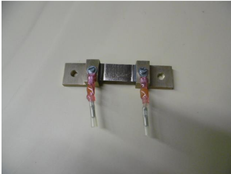
Bild 3: Shunt, neue Installation
