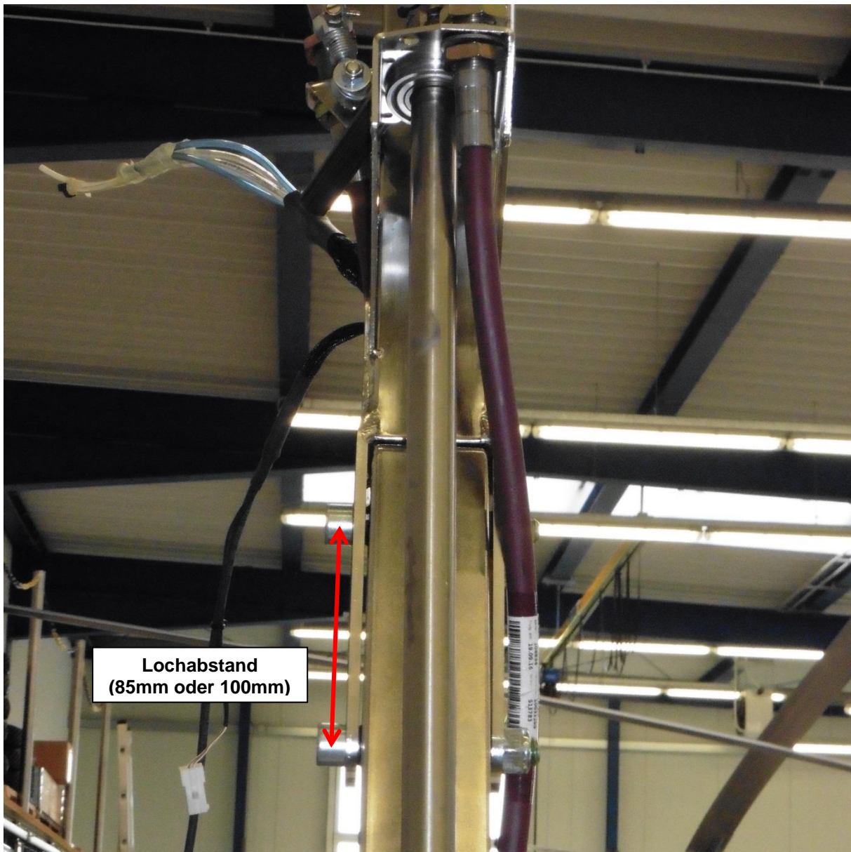
Bild 3: Calidus Verbindung oberer / unterer Mast - Lochabstand
