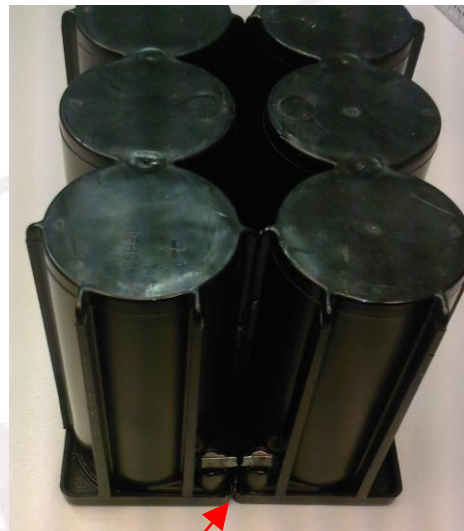
4.2 Beispiel einer gebrochenen Brücke
