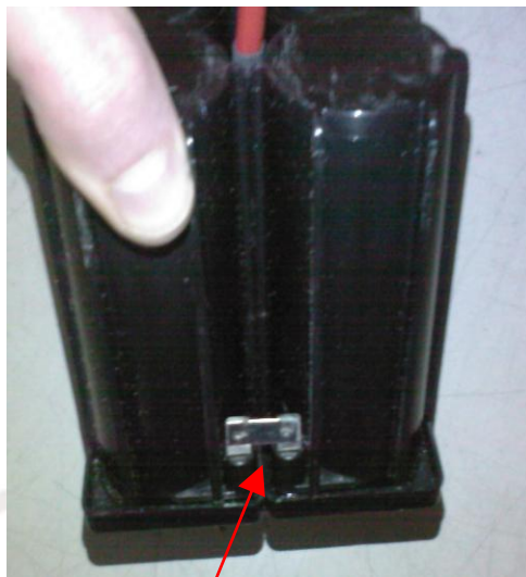
4.1 Batterie-Brücke nicht verstärkt
