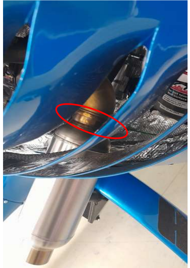
Schweißnaht ist bei montierten Verkleidungen sichtbar
