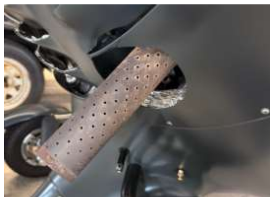
Überreste, nachdem sich das Nachschalldämpferteil im Flug gelöst hat
