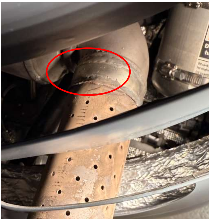
Gerissene Schweißnaht, Nachschalldämpfer abgefallen
