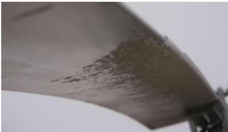
Foto eines Rotorblatts mit starker Vereisung
