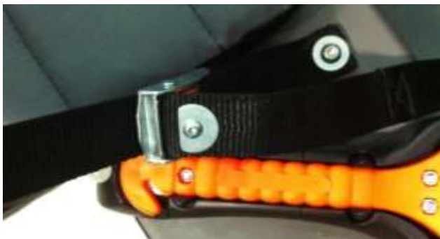
Ansicht der montierten Verstellriemenschlge - bestehend aus 2 Unterlegscheiben, Schraube und Sicherungsmutter pro Verstellriem.
