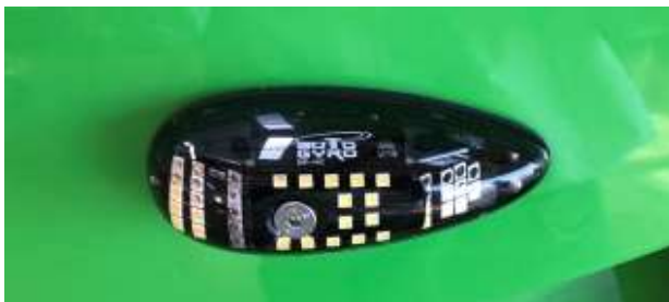
Ansicht eines nicht zertifizierten AutoGyro-Navigations- und Strobe-Lichts, nur für Tag-VFR
