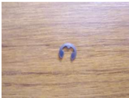
Sicherheitsclip am Mutterende der Scharnierstifte
