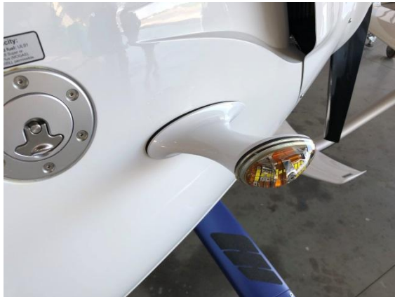
Ansicht der am Stiel montierten zertifizierten Navigations- und Blinkleuchte
