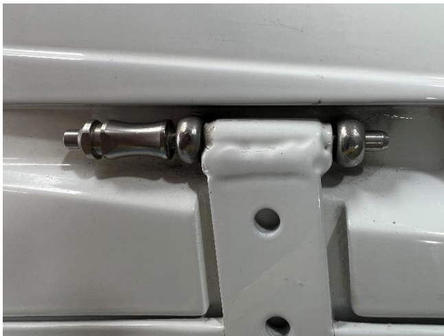
Ansicht des Türscharnierstifts. Die Einbaurichtung des Bolzens beachten.
