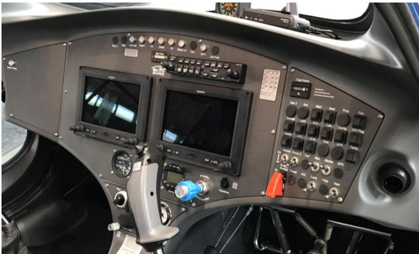
Beispiel eines Panels aus dem Cavalon 915 mit eingebauter blauer Propellersteuerung (und Dual Panel Garmin G3x).
