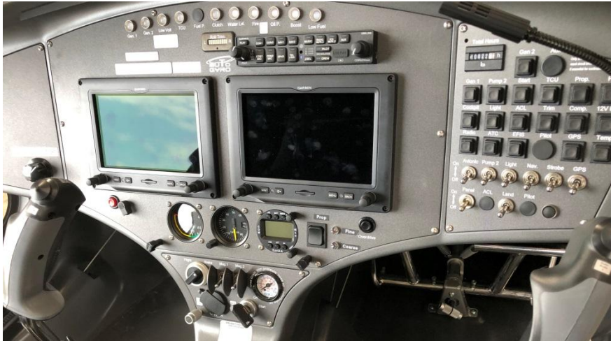
Beispiel für eine doppelte G3X-Installation
