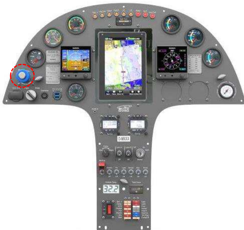
Beispiel eines Panels von MTO Sport 2017 915iS/916iS mit blauer Propellersteuerung
