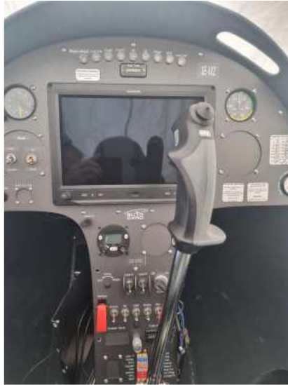
Beispiel G3X Installation
